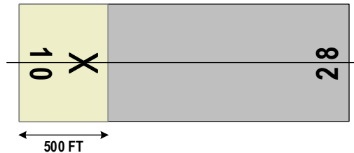
Figure 26: Fermeture partielle de piste (longueur réduite)
